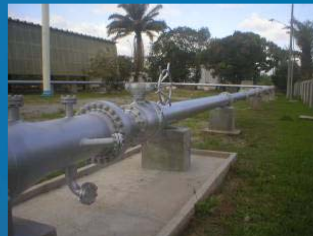
Circuito de teste de 14" com 100 m de comprimento
