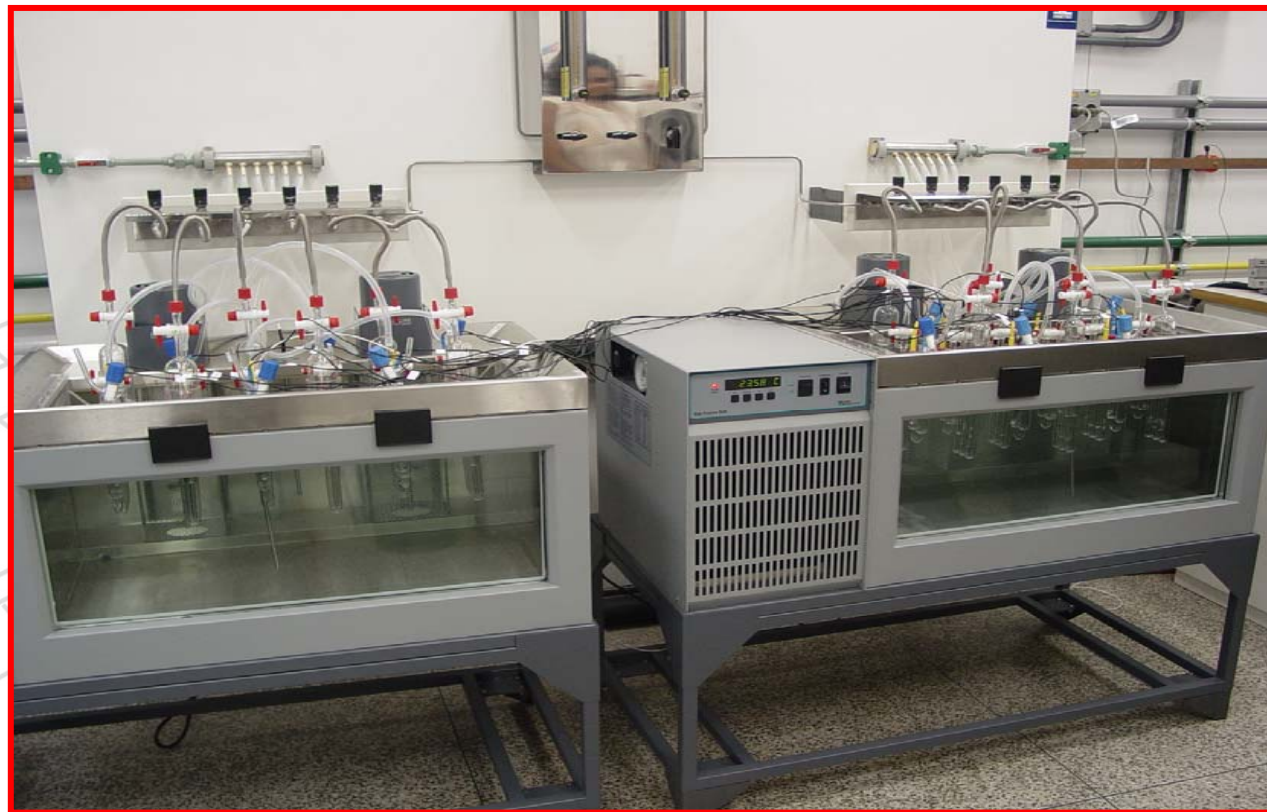
Sistema primário de medição de pH (célula Harned)
